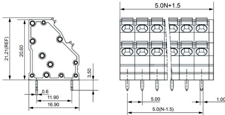
备注：(1) 产品部分外形尺寸未注尺寸公差，当外形尺寸 $\leq 1\text{mm}$ ，公差为 $\pm 0.2\text{mm}$ ；当外形尺寸在 $(1\sim 5)\text{mm}$ 之间时，公差为 $\pm 0.3\text{mm}$ ；当外形尺寸 $> 5\text{mm}$ ，公差为 $\pm 0.4\text{mm}$ ；
